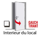
Intérieur du local GAUCHE TIRANTE
