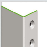
Perçage/ fraisage du blindage
